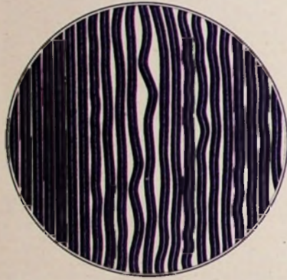
Bild 5. Schallplatten nach dem Rheinschen Füllschrift-Verfahren besitzen einen ungleichmäßigen, elektrisch gesteuerten Rillenabstand, den das elektrische Rechenggerät der wechselnden Lautstärke feinnervig anpaßt. Es ergibt sich ein Raumgewinn bis zu 70 %. Links: Sieben Rillen ohne Musik
