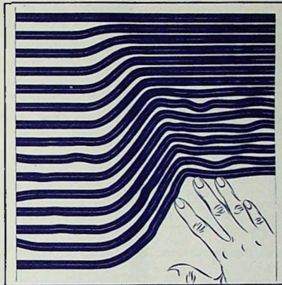
Bild 2. Wie das Rheinsche Füllschrift-Verfahren arbeitet, zeigt dieses Bild. Bei der Aufnahme werden die Tonrillen in exakter Anpassung an die wechselnde Lautstärke wie von unsichtbarer Hand so nebeneinander gelegt, daß kein Raum mehr verschwendet wird. Der Raumgewinn kommt je nach Bedarf der Spieldauer, der Qualität oder dem Preis der Platte zugute
